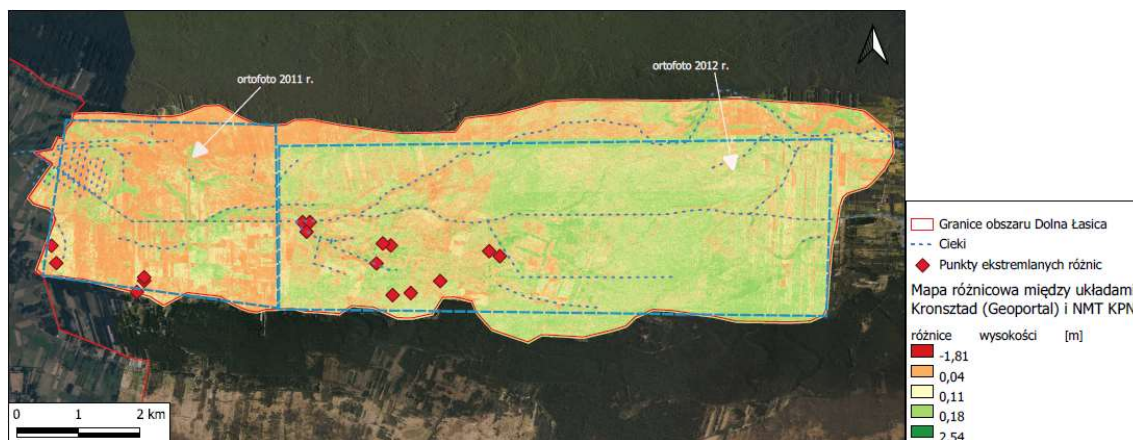
Rycina 9: Weryfikacja NMT (geoportal i LIDAR) dla obszaru Dolna Łasica. Źródło: Opracowanie własne.
