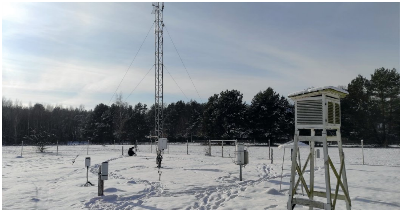
↑ Stacja meteorologiczna w miejscowości Granica koło Kampinosu. To tu od 1994 r. prowadzone są pomiary wielkości opadu, temperatury powietrza, kierunku i prędkości wiatru oraz wielu innych parametrów (fot. Anna Andrzejewska)
